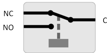
Funcionamiento interno del relé programable
