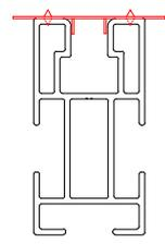
Montar la chapa toma tierra con los pines hacia abajo y centrada en el carril superior del perfil.
