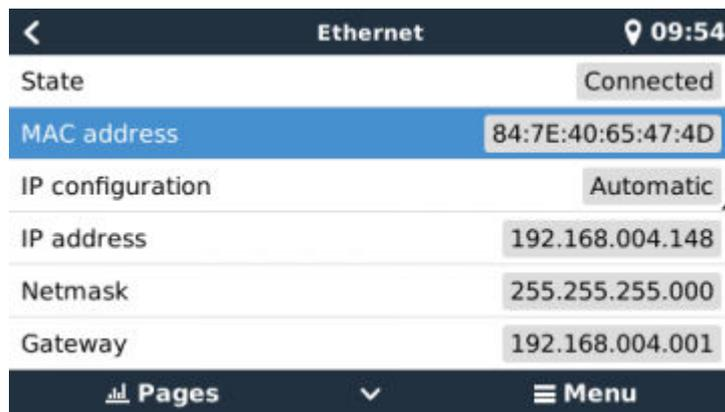
Quando usar uma Ethernet e o Estado indicar “Desligado”, comprove que o cabo de rede Ethernet não está danificado. Caso contrário, experimente com outro. As duas luzes na parte posterior Cerbo GX, onde o cabo Ethernet RJ45 é inserido, devem estar acesas ou intermitentes. As duas luzes apagadas indicam um problema de ligação.
