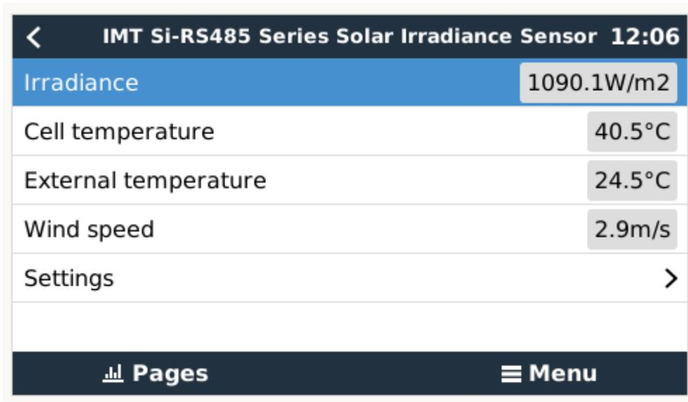
No submenu “Definições” é possível ativar manualmente e desativar quaisquer sensores externos adicionais/opcionais que estejam ligados ao sensor de irradiância IMT Si-RS485 Series.
