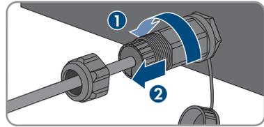
7. Desbloquee el conector del cable de red y retírelo del conector hembra del inversor.
