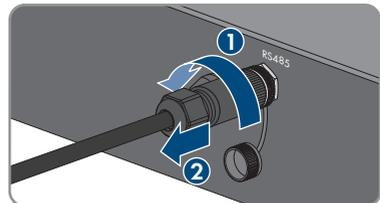
4. Enrosque la tapa de protección en el conector hembra RS485.
