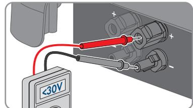
8. Compruebe que no haya tensión en las entradas de CC entre el polo positivo y tierra y el polo negativo y tierra con el equipo de medición adecuado.
