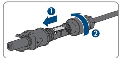
5. Deslice la tuerca de unión hacia la rosca y apriétela (par de apriete: 2 Nm).
