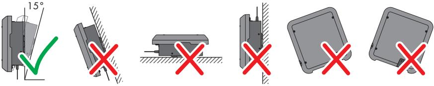
Imagen 5: Posiciones de montaje permitidas y no permitidas
