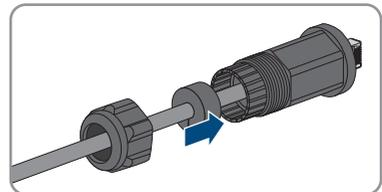
6. Inserte el conector de red del cable en la hembrilla de red del inversor y gire el casquillo roscado sobre la rosca de la hembrilla de red del inversor.
