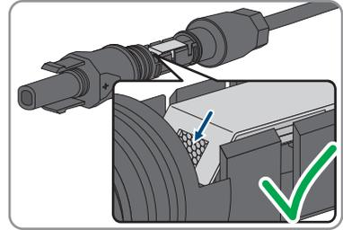
4. Si el cordón no es visible en el hueco, el cable no está colocado correctamente y el conector de enchufe debe volver a prepararse. Para ello, se debe volver a retirar el cable del conector.
