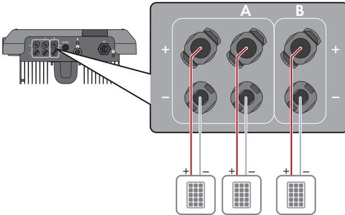
Imagen 9: Vista general de la conexión en el funcionamiento normal
