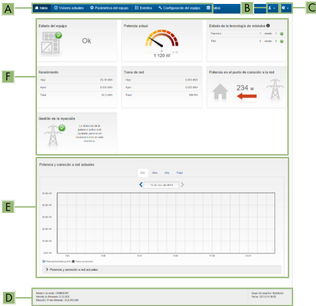
Imagen 13: Estructura de la página de inicio de la interfaz de usuario (ejemplo)
