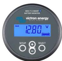
Deteção de Bluetooth BMV-712 Smart Battery Monitor
