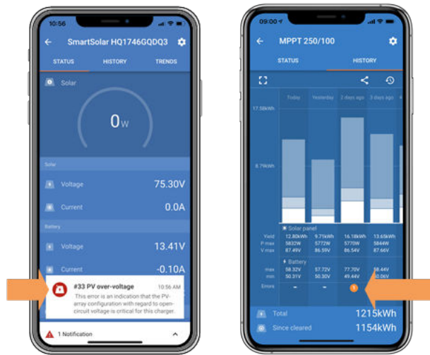
VictronConnect: captura de ecrã de um Erro #33 e captura de ecrã do histórico com indicação de um erro.
